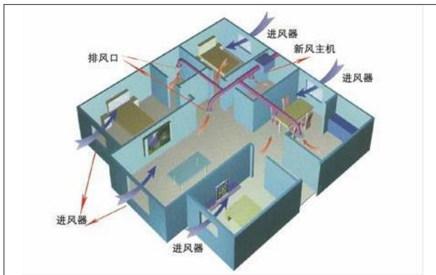
图 4-3 新风系统原理示意图
